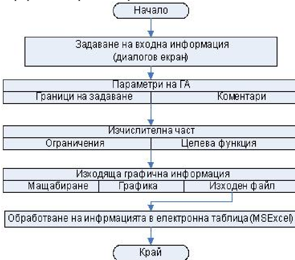
Фиг.2. Обобщена блок-схема на процеса за преработване на информацията в системата, реализираща генетичния алгоритъм
